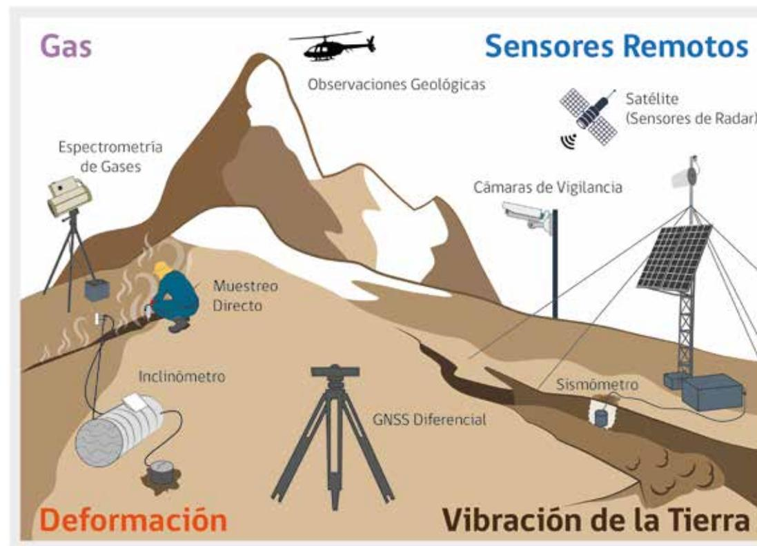
Figura 7. Esquema de las diferentes técnicas de monitoreo volcánico utilizadas en el país.
